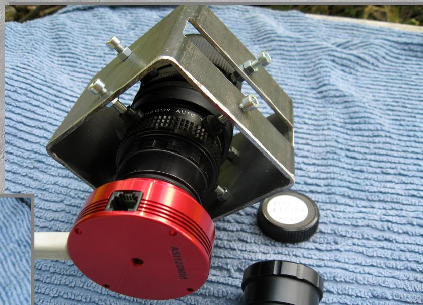
..Spero che le foto allegate rendano l'idea. Nel raccordo 42-1/31,8 (visibile anche vicino al tappo del tele) è possibile inserire direttamente o dopo una barlow2X - 3X un oculare 31,8 come pure in stessa configurazione la ASI120MM. In tutti i casi si raggiunge una perfetta messa a fuoco. Per il fissaggio alla montatura, ho saldato in un angolo del quadrato 2 ferri a forma di coda di rondine, poco visibile nelle foto ma facilmente intuibile..
