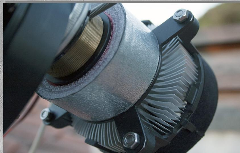
..raffreddamento della camera ASI 120MM tramite un dissipatore e ventola di un PC e di una cella peltier di 40x40mm a 12v, realizzato da Valerio Fontani (SdR Luna UAI)..
