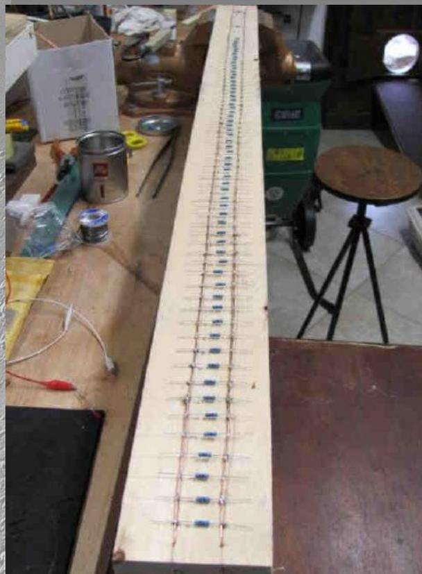
la fase di saldatura delle 76 resistenze da 470 ohm poste in parallelo, in questa fase ho fatto uso di una tavola pre-marcata che ha permesso il giusto tensionamento del filo conduttore velocizzando le operazioni di saldatura e posizionamento delle resistenze.
